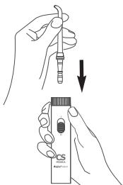
Возьмите Вашу индивидуальную насадку из пенала для хранения насадок и установите ее на ручку ирригатора до щелчка таким образом, как показано на рисунке.
