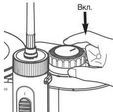
**Важно:** после каждого включения регулятора на основном приборе не забывайте включать подачу струи жидкости на ручке ирригатора, в противном случае подача струи будет заблокирована, сработает система защиты двигателя и прибор отключится.
