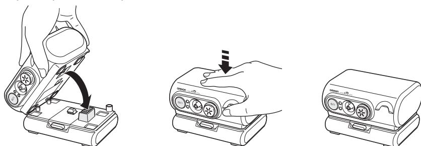
**Примечание:**Чтобы разъединить компрессор и батарею, нажмите кнопку сбоку батареи и поднимите с нее компрессор.
